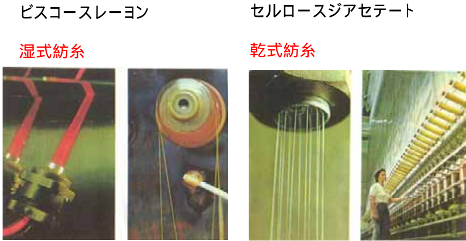
図5 . ビスコースレーヨンの湿式紡糸とセルロースジアセテートの乾式紡糸
